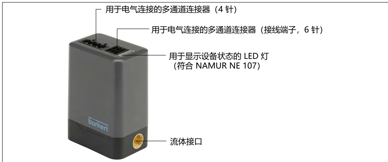
图 1: 压力调节器的结构，数字版本
